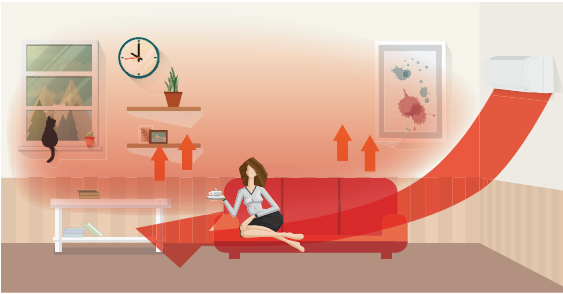
Isıtma: Yatay kanatlar aşağıya doğru bakar.
