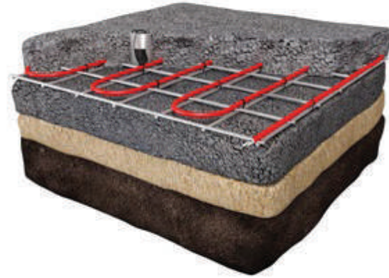
Silindirle sıkıştırılmamış asfalt içine uygulama
