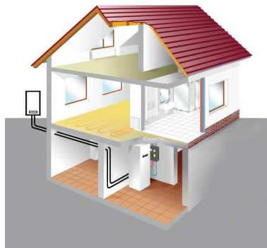
Vitalocal 111-S ile ısıtma, soğutma ve sıcak su üretimi.
